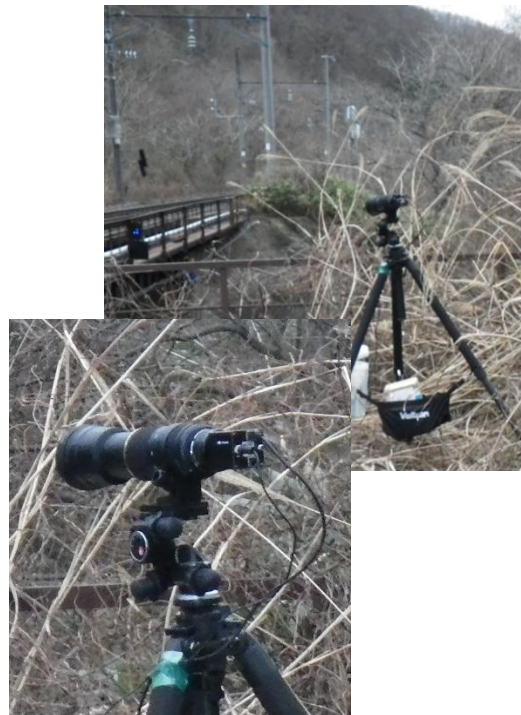
光学式変位測定システム (現地での設置イメージ)
